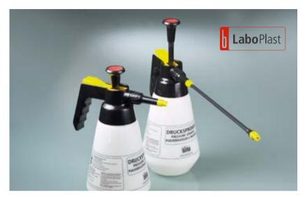
Высококачественный, прочный промышленный пульверизатор для дезинфекции, очистки, защиты растений, тонкослойной хроматографии, решения различных технологических и санитарных задач. Давление в ёмкости до 4 бар создается с помощью ручного насоса. Затем производится распыление нажатием кнопки.
