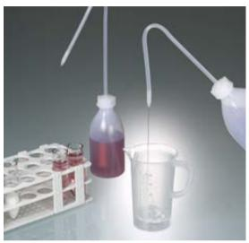
Изогнутая трубка оснащена распылителем, который образует абсолютно ровную струю. Исключается опасное разбрызгивание.
