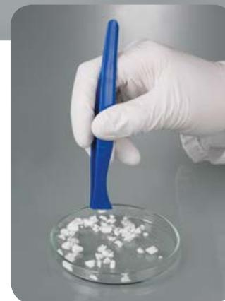
Одноразовые пинцеты подходят для высокоточных работ в лаборатории. Они идеальны для захвата, удержания и перемещения небольших предметов, например, тонких тканей, малых объектов или твердых проб.
