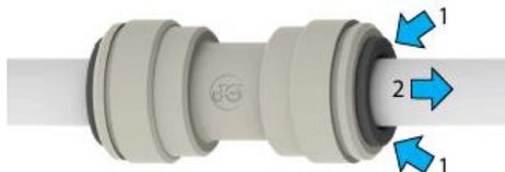
Рисунок 7. Отсоединение трубок
