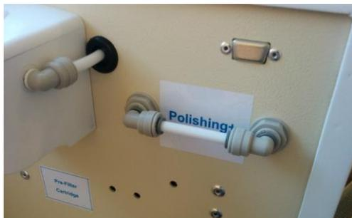
Рисунок 34. Установленная перепускная трубка.
