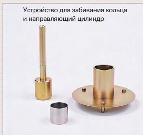
Устройство для забивания кольца и направляющий цилиндр
