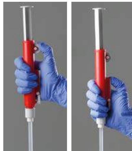
Всасывание вращением колесика. При остановке вращения колесика поршень перестает двигаться без утечки отобранной жидкости.
