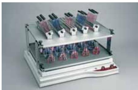
**3019** Аналогичный орбитальный шейкер с рамочным стеллажом 3981, платформами 3980 (2), штативами для пробирок 3953 и зажимами для конических колб 3983–3990
