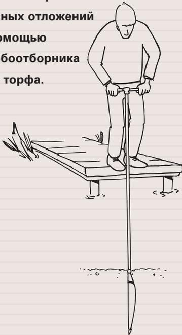
**С помощью бура Эдельмана проводится предварительное бурение, далее в скважину опускается торфяной бур и отбирается проба.**
