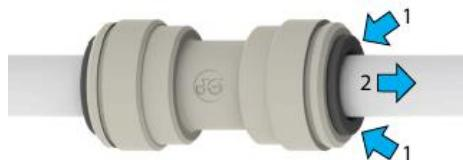
Рисунок 7. Отсоединение трубок
