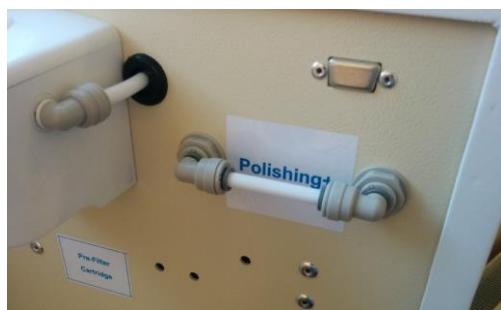
Рисунок 34. Установленная перепускная трубка.
