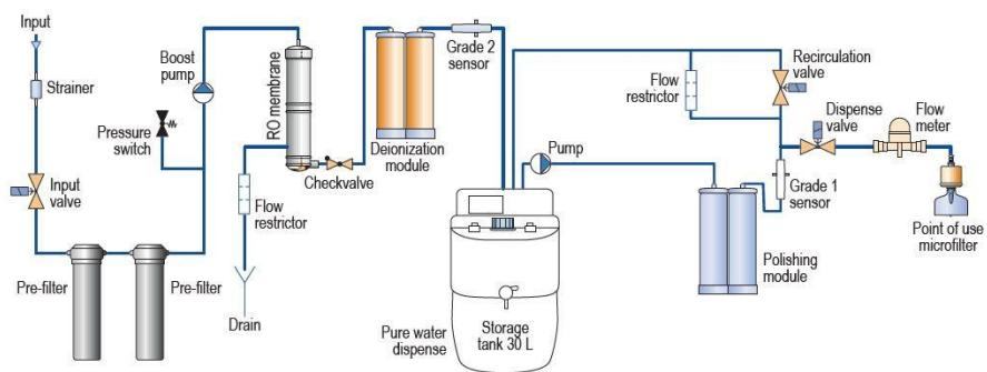
Рисунок 2. Схема модели Labaque Trace
