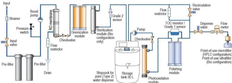
**Рисунок 3. Схема моделей Labaqua HPLC / Bio**
