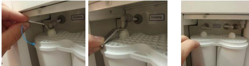
Рисунок 33. Замена модулей тонкой очистки и деионизации.
