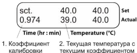
**Рис. 3. Панель управления в режиме калибровки**
