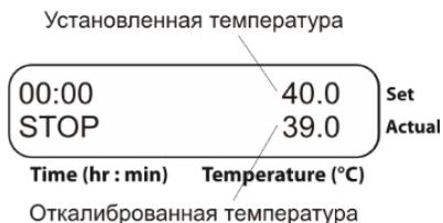
**Рис. 4. Панель управления в рабочем режиме после калибровки**
