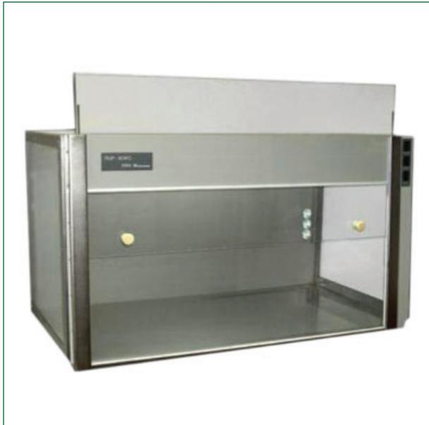
ПЦР-бокс предназначен для организации изолированного от внешней среды пространства в клинико-диагностических и ПЦР-лабораториях (табл. 6).
