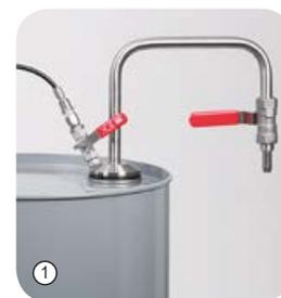
Система для отбора растворителей позволяет осуществлять быстрый и удобный розлив жидкостей высокой степени очистки. С помощью сжатого газа (сжатого воздуха или азота) в таре создаётся избыточное давление, вытесняющее жидкость из ёмкости. Преимущество использования сжатого газа состоит в том, что пользователь без труда может производить также отбор больших объёмов. При этом для розлива растворителя у него остаются свободными обе руки.
