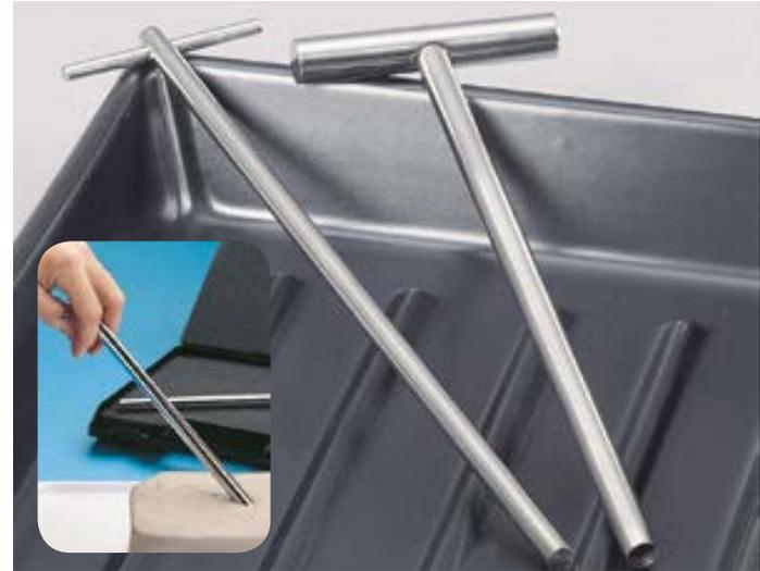
Цилиндрический полый ручной бурав с острой режущей кромкой. При вращении легко врезается в пастообразные и полутвердые вещества. Срезанную пробу удаляют из полости бурава с помощью выталкивающего штока. Общая длина 260 мм. Внутренний диаметр 8 мм, внешний диаметр 10 мм.
