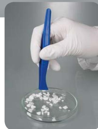
Одноразовые пинцеты подходят для высокоточных работ в лаборатории. Они идеальны для захвата, удержания и перемещения небольших предметов, например, тонких тканей, малых объектов или твёрдых проб.
