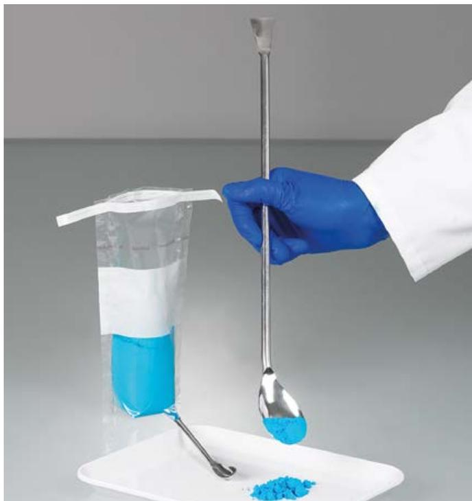
Ложка для отбора проб небольшого объёма. Ложка имеет специальную форму, позволяющую легко достать до каждого угла контейнера. Также благодаря форме ложки отобранный образец не рассыпается.
