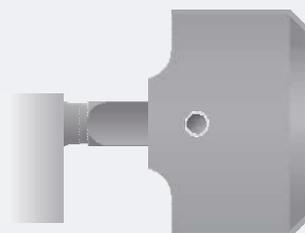
После окончания центрифугирования бакеты могут не полностью вернуться в исходное положение (например, из-за недостаточно смазанных опорных болтов ротора или асимметричной нагрузки).
