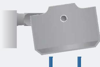
Три металлических штифта выходят из дна камеры и слегка приподнимают бакет для достижения точного позиционирования.
