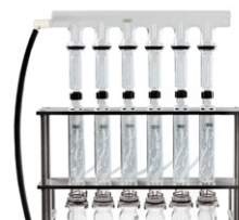
Reflux Setup С водяным или воздушным обратным холодильником
