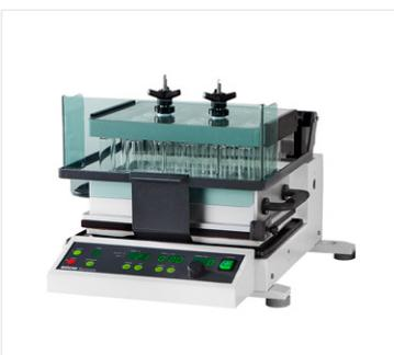
Syncore® Analysts R-6/R-12 упаривает экстракты до предварительно заданных остаточных объемов. Кроме того, он сочетает в себе очистку SPE с концентрированием элюента.
