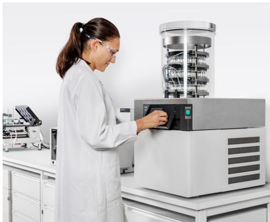
Увеличение давления можно проверить путем закрывания клапана между камерой с продуктом и камерой конденсора. При изоляции камер давление в камере с продуктом растёт из-за лиофилизации молекул воды. По мере снижения концентрации молекул воды кривая роста давления постепенно выравнивается. Конечная точка – это точка, в которой давление больше не увеличивается.
