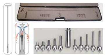
Предназначен специально для отбора очень малых по объёму проб сильнодействующих, дорогостоящих или химически активных порошкообразных препаратов. С помощью пробоотборника «ФармаПикер» (PharmaPicker) можно отбирать пробы очень малого объёма – от 0,1 до 2,5 мл. С помощью простой смены наконечников в цилиндрах для сбора образца для 0,1-1,2 мл или 1,25-2,5 мл меняется объём.
