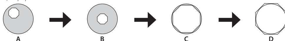
Рис. 10 Перемещение изображения ирисовой диафрагмы осветителя микроскопа
