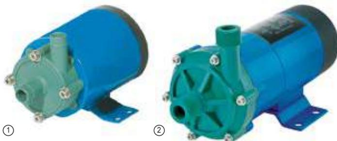
Новые магнитные центробежные насосы предназначены для перекачки кислот, щелочей, растворов для щелочных ванн и гальванических растворов, фотографических растворов, а также радиоактивных, стерильных и коррозионноактивных жидкостей. Эти насосы являются бессальниковыми. Герметичность насоса достигается за счет использования бесконтактного магнитного привода, не требующего герметизации вращающегося вала.
