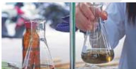
Для определения точки нейтрализации к исходному раствору добавляют 1-2 капли реагента (фенолфталеина). Когда раствор образца становится щелочным, фенолфталеин меняет цвет. Можно определить, сколько кислоты содержится в исходном растворе, наблюдая за количеством щелочного раствора, который был добавлен, пока раствор образца не изменил цвет (не достигла точки нейтрализации).
