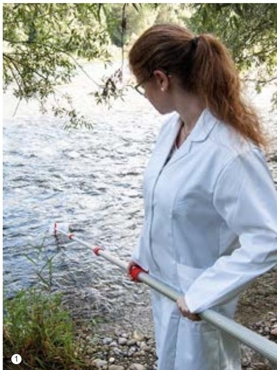
Универсальное приспособление для отбора проб „ТелеСкуп“ (TeleScoop) с возможностью установки различных инструментов для решения широкого круга задач. Заменяемые устройства (наклонный стакан, маятниковый стакан, держатель для бутылей, стакан из нержавеющей стали) устанавливаются на телескопический шток с помощью удобного зажима-защелки.
