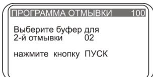
Рисунок 7. Выбор бутыли для промывки по второму каналу
