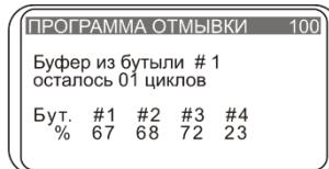
Рисунок 8. Дисплей при работающей программе и с подключённым терминалом контроля объёма жидкости
