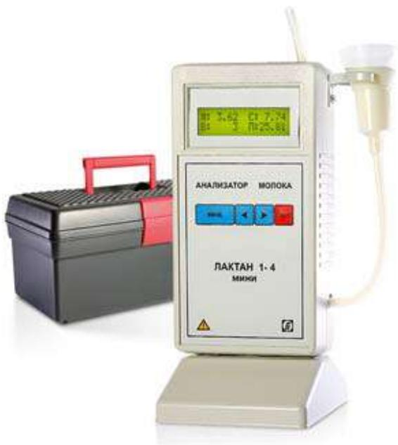
**«Лактан 1-4М» исполнение Мини это переносной, малогабаритный, экспресс индикатор молока с возможностью автономного питания от автомобильного аккумулятора.**
