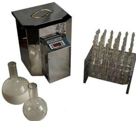
**Водяной термостат для проведения анализа жира** по ГОСТ 5867-90 (выдерживание бутирометров в водяной бане при температуре  $65\pm 2^{\circ}\text{C}$  в течении 5 минут).
