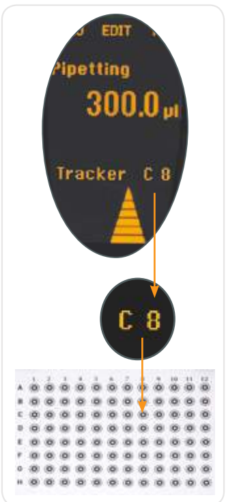
Функция отслеживания заполнения микропланшета в действии
