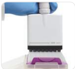
При установке наконечника на дозатор будьте аккуратны и пользуйтесь специальным механизмом Optiload.
