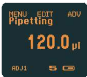
Настройка калибровки в действии, на что указывает ADJ1
