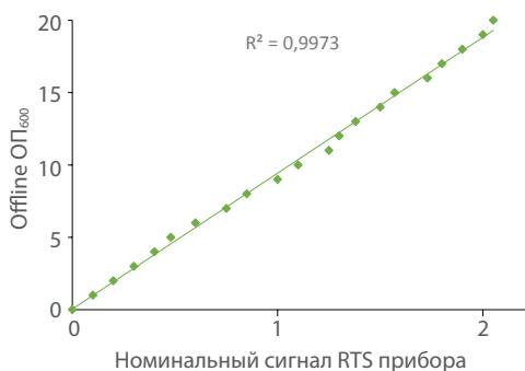
Рис. 7. Квадратичный коэффициент линейной корреляции ( $R^2$ ) рассчитанных значений оптической плотности между данными полученными на RTS и на спектрофотометре ( $\text{ОП}_{600}$ ). Калибровочная кривая получена для *E.coli* BL 21.
