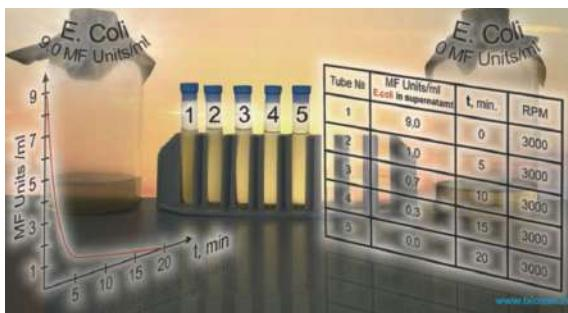
Применение денситометров для определения концентрации микробных клеток супернатанта в пробирках в течение центрифугирования. Показатель мутности измеряется в единицах Мак-Фарланда.
