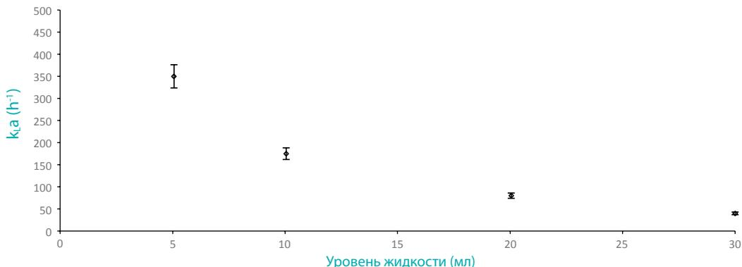
Рис. 3. Влияние различных объёмов среды на скорость ее насыщения кислородом в 50 мл ТРР Биореакторе при интенсивном реверсивном вращении на RST-1C. Заполнение осуществляли де-ионизованной водой объёмом 5, 10, 20 и 30 мл и измерения осуществляли не инвазивным O<sub>2</sub> датчиком и оптикой (PreSens, Германия) при 37 °C используя метод полного вытеснения растворенного кислорода-азотом. На Рис. 3 представлены средние значения как минимум 5 экспериментов а также их среднеквадратичные отклонения.
