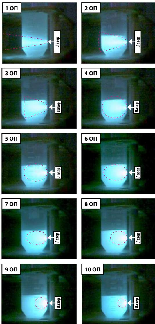
Рис. 5. Фотографии, отображающие светорассеяние клеточных супензий *Saccharomyces cerevisiae*, (снимки сделаны под углом 90 градусов относительно светового потока; длина волны света 535 нм; диапазон оптической плотности от 1 до 10 с шагом в 1 ОП.) Штриховыми линиями выделены особенности распространения светового потока в зависимости от концентрации клеточной супензии.
