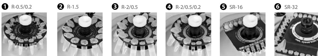
Центрифуга-вортекс Мульти-Спин является продуктом многолетней эволюции «Спин-Микс-Спин» – технологии, предназначеннной для «сброса» микрообъемов реагентов на дно пробирки (первое центрифугирование – спин), последующего перемешивания (микс) и повторного сбора реагентов (повторный спин) со стенок и пробки микропробирок. Этот повторяющийся алгоритм операций, имеющий целью снизить ошибки пробоподготовки для ПЦР-анализа, мы назвали «смс-алгоритмом».
