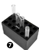
Combitherm-2 **Ch 3-150** предназначен для термостабилизации материалов при различных температурах в диапазоне от -3°C до +150°C в соответствии с методикой анализа.
