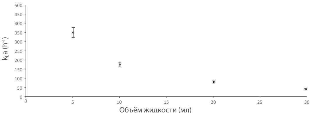
Рис. 9. Определение  $k_{l,a}$  в 50 мл фальконах биореакторах TPP. Биореакторы были заполнены деионизированной водой объемом 5, 10, 20, и 30 мл, измерения проводились с помощью не инвазивных датчиков  $O_2$  и оптики (PreSens, Regensburg, Germany) при 30 °C с использованием метода "gassing-out". Показано среднее и стандартное отклонение пяти независимых экспериментов.
