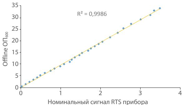
Рис. 8. Квадратичный коэффициент линейной корреляции ( $R^2$ ) рассчитанных значений оптической плотности между данными полученными на RTS и на спектрофотометре ( $\text{ОП}_{600}$ ). Калибровочная кривая получена для *P.pastoris*.
