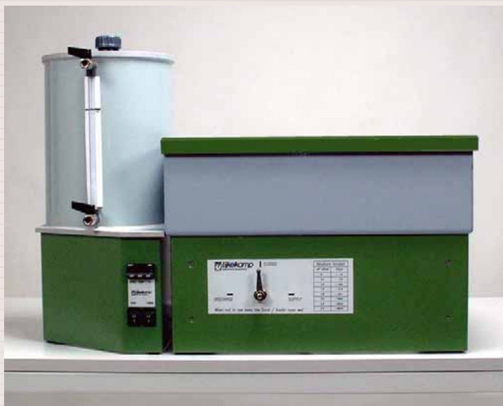
Песочница для песка/каолина для определения рF (рF 2,0 - 2,7)
