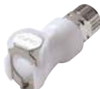
Быстроразъёмные соединения (гнездового типа), номинальный диаметр отверстия 6,4 мм, соединение для трубок с резьбовыми наконечниками
