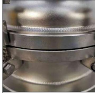
Процесс сварки рыбьей чешуи, отсутствие подрезов, отсутствие пористости, хорошая воздухопроницаемость, прочная структура
