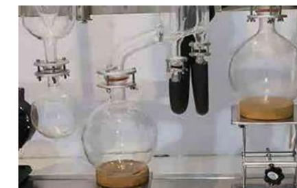
Колба для сбора - GG17 материал высокопрочное боросиликатное стекло, антикоррозийный. С регулируемым подъемным стендом. Колбы для сбора тяжелых и легких молекул, объем и материал по выбору.
