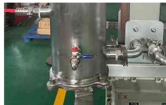
Порт подачи с системой фильтрации, которая может выполнять первичную фильтрацию фильтрация при подаче пробы.
