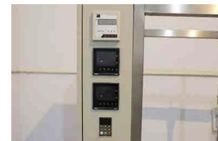
Контроллер - температурный контроллер марки Omron. Отображение вакуума с единицами измерения Торр, мБар, Па. Настройка и отображение скорости.
