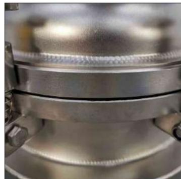
Процесс сварки в рыбьем масштабе, без подрезов, без пор, хорошая герметичность, прочная структура и эстетика мастерства.
