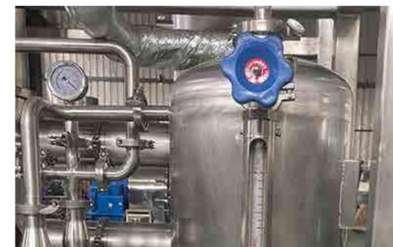
Передачный резервуар соединяется с криогенным охладителем для регенерации этанола. Включает в себя датчик уровня жидкости и фильтр, который может видеть уровень собираемой жидкости и выполнять повторную фильтрацию перед восстановлением.
