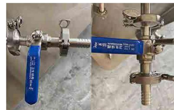
Впуск жидкости, выпуск жидкости, клапан сброса давления, впуск охлаждающей жидкости и выход, манометр и т.д. могут быть быстро установлены и демонтированы.
