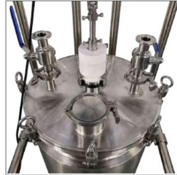
Быстросъемная многофункциональная крышка реактора, с такими функциями, как подача, измерение температуры, механическое уплотнение вала, выход и т.д.
