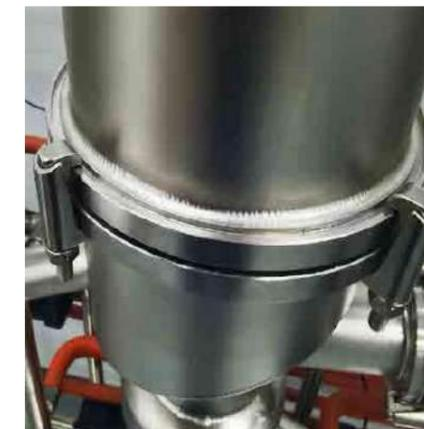
Использование процесса сварки с поворотом, точка сварки в виде рыбы, в соответствии с технологией сварки Японии и Германии
