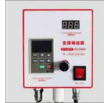
Скорость вращения мешалки отображается в реальном времени и может быть отрегулирована в соответствии с вязкостью материала и потребностями реакции.
