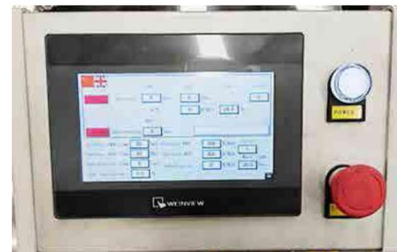
Сенсорный экран управления с программой PLC и измерением температуры устройства, температура в реальном времени может отображаться на дисплее.
