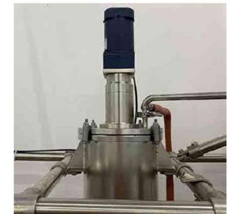
Магнитное уплотнение, специальное уплотнение высокого вакуума, максимальное вакуум может быть в пределах 1Па (в обычных стеклянных реакторах используются механические уплотнения, которые не могут достичь предельного вакуума).
