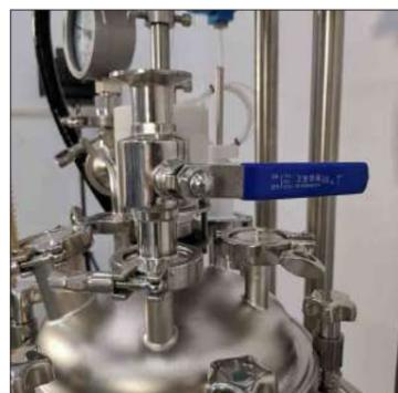
Корпус реактора из нержавеющей стали полирован электролитическим способом, корпус и внешняя поверхность реактора имеют одинаковый цвет, долговечный блеск, гладкую поверхность и более сильную коррозионную стойкость.
