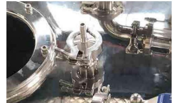
Вакуумный порт с быстрым зажимом, может соответствовать вакуумному насосу для
