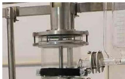
Система магнитного соединения - из нержавеющей стали SUS316L. Термостойкий многоуровневый источник сильного магнитного привода. Импортные износоустойчивые высокотемпературные и коррозионностойкие подшипники из Германии.
