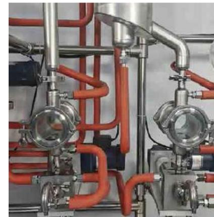
Автоматический легкий компонент и тяжелый компонент разряжение и внешний конденсатор + холодоуловитель с окном для легкого наблюдения
