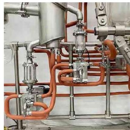
Использование шестеренчатых насосов для привода автоматической подачи и автоматическая разгрузка, для небольшой молекулярной дистилляции пилотного уровня, для повышения производительности
