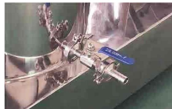
Тип с рубашкой и загрузочным отверстием, может соединяться с рециркуляционным охладителем для охлаждения.
