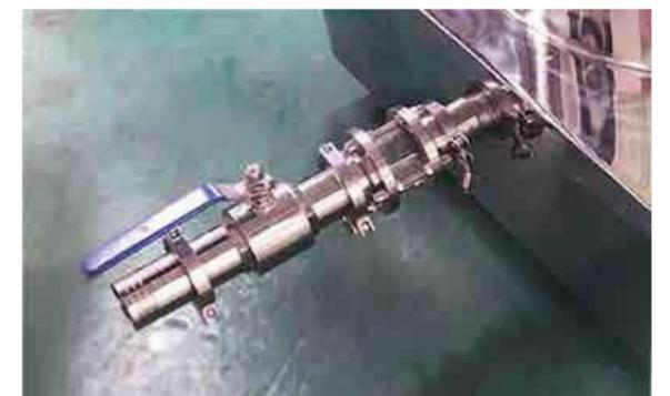
Разгрузочное отверстие с клапаном контроллера.
