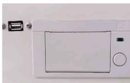
Интерфейс USB, встроенный микропринтер
