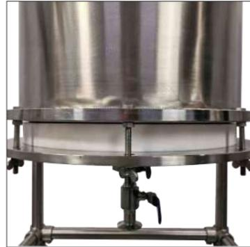
Фланцевое соединение фторопластового основания фильтра удобно для разборки, очистки и замены
