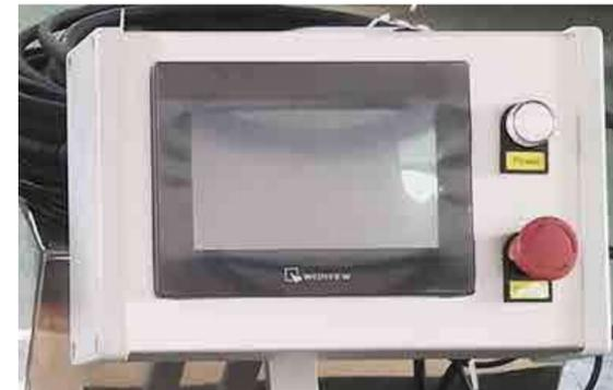
Сенсорный ЖК-экран, система контроллеров PLC. Шкаф управления частотой.
