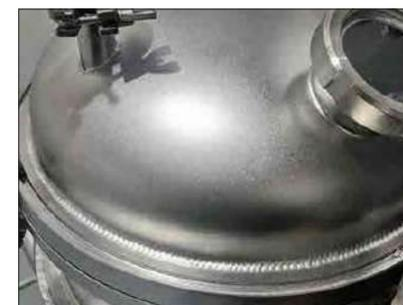
Сварка рыбьей чешуи, без подрезов, без пор, хорошая герметичность, прочная структура
