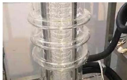
Главный испаритель - испаритель с рубашкой, змеевидный змеевик конденсации для улучшения площади конденсатора, SS316 с графитовым композитным материалом скребка, устойчивость к высоким температурам 300°C.
