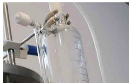
Резервуар для загрузки - может быть изготовлен на заказ в соответствии с запросом, например, объем, тип рубашки, материал из нержавеющей стали.
