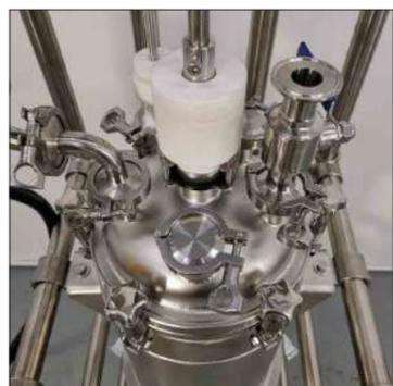
Быстросъемная многофункциональная крышка реактора позволяет легко разобрать соединительную головку для соединения различных деталей и продлить срок службы крышки реактора.
