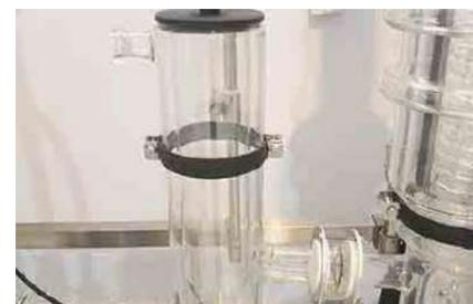
Холодная ловушка - можно добавить сухой лед или жидкий азот и т.д. Также можно сделать OEM.
