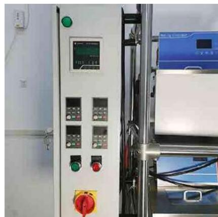
Блок управления управляет масляным насосом, главным испарительная камера, автоматическая подача, автоматическая выгрузка, импортные материалы, долговечность
