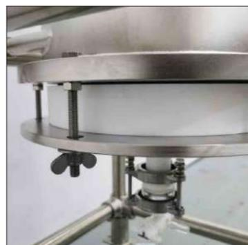
Фильтрующее устройство PTFE разборная фильтрующая пластина PTFE с песчаным сердечником
