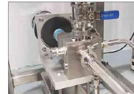
Оборудован шестеренчатым насосом, может осуществлять непрерывную и автоматическую подачу и разгрузку в вакуумном состоянии
