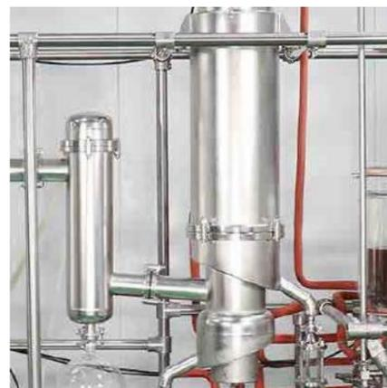
Основной испаритель, материал SUS, улучшенная тепловая проводимость, хороший эффект испарения и не легкое повреждение
