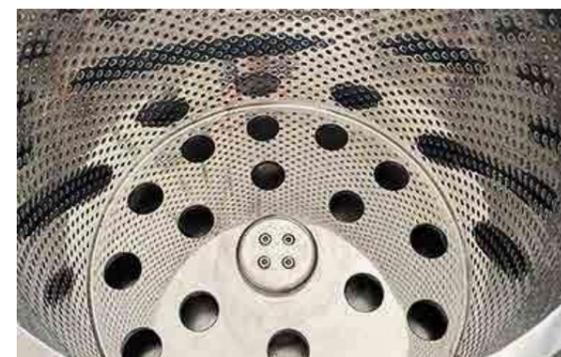
Центробежный перфорированный барабан из нержавеющей стали S316, общий вид красиво, и материал высыхает более равномерно.
