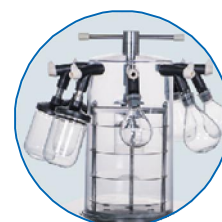
D: Модель с верхним прессом и несколькими коллекторами
