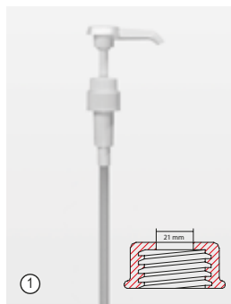
① «Доси-Памп» (Dosi-Pump), 4 мл Стандартное дозирование примерно 4 мл/такт.
