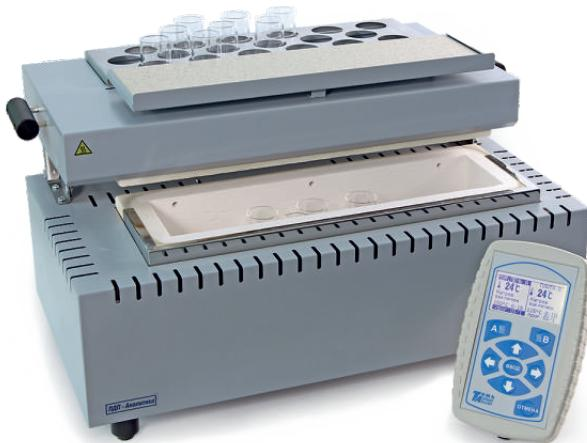
Программируемые муфельные печи, совмещенные с нагревательной плитой, представляют собой компактные, быстродействующие устройства, позволяющие проводить одновременное выпаривание и озоление проб. Имеют камеру муфельного типа и размещенную на ней нагревательную плиту.
