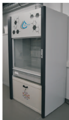
Вытяжной шкаф для шкафов безопасного хранения
