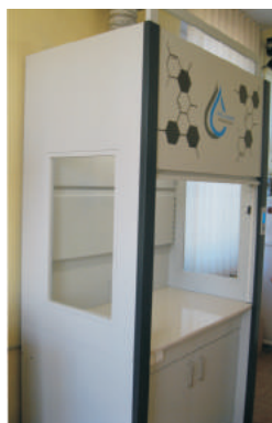
Вытяжной шкаф со стеклянными окошками в боковых стенках
