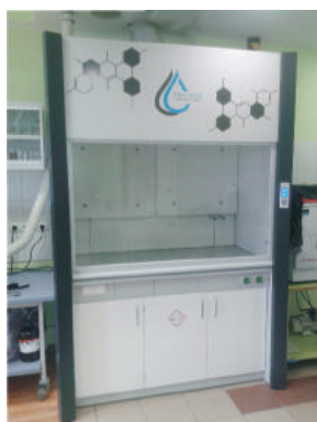
Вытяжной шкаф с ящиками из полипропилена
