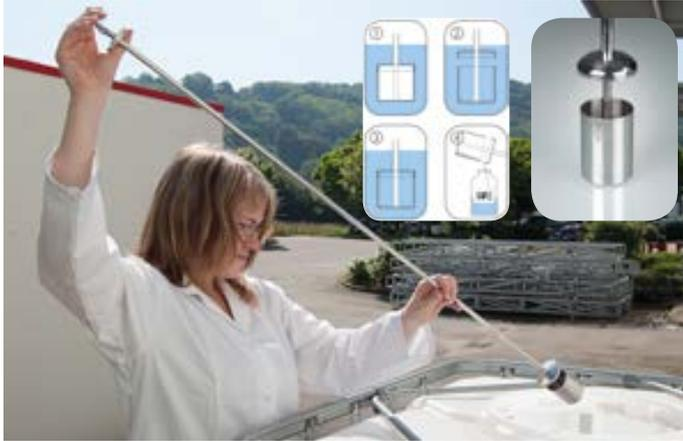
Пробоотборник с чашкой „Ликвид КапСамплер“ (Liquid CupSampler) из нержавеющей стали AISI 316L (1.4404) предназначен для точечного пробоотбора жидкостей с различной вязкостью. А также для пробоотбора суспензий.
