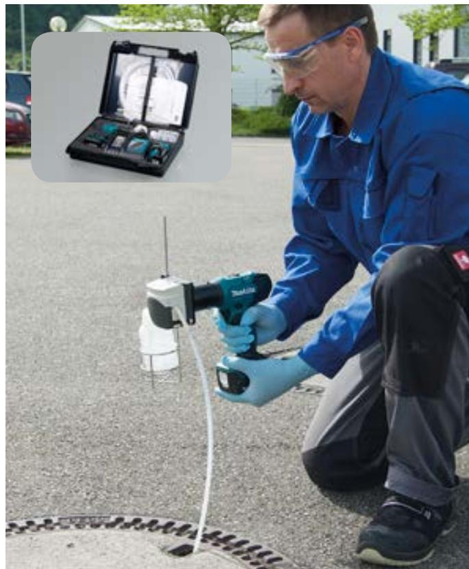
Портативный насос для жидкостей с питанием от аккумуляторов. Специально предназначен для отбора проб из бочек, цистерн, колодцев, водоотстойников, канализации и очистных сооружений.
