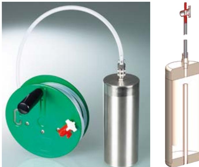
Погружной цилиндр «Таргет» (Target) предназначен для проведения точечного пробоотбора жидкости.
