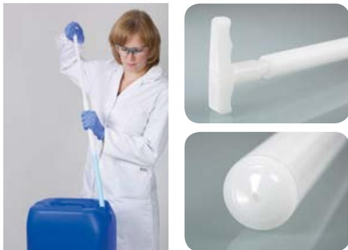
С помощью одноразового пробоотборника «Ликвидиспо» (LiquiDispo) возможен отбор проб в диапазоне от жидкостей до слабвязких жидких субстанций. Эргономичная ручка облегчает взятие пробы, поскольку возможно всасывание объема до 200 мл так же, как шприцем.
