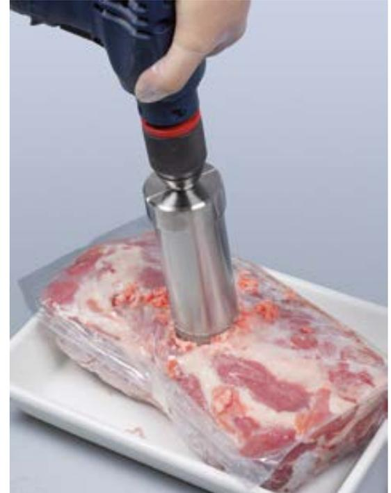
Предназначен для отбора проб глубоководных продуктов в пищевой промышленности, а также для отбора проб полутвердых веществ. Прочный полый бур с расположенной на его конце коронкой с острыми зубцами, быстро врезается в анализируемое вещество. Бур позволяет отбирать многоуровневые пробы в форме цилиндра высотой до 20 см.
