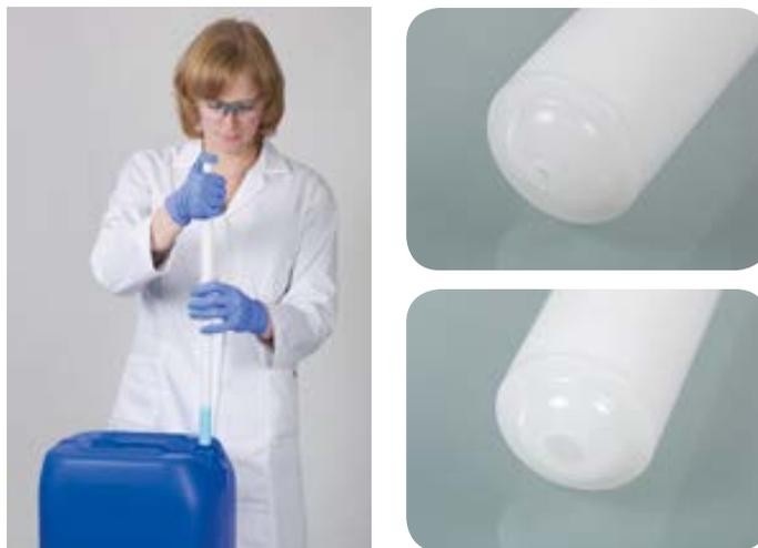
Простой одноразовый пробоотборник для отбора жидкотекучих субстанций. Если «ДиспоПипетт» (DispoPipette) вводится в жидкость в открытом состоянии, тогда отбирается многоуровневая проба. Если же осуществляется ввод в закрытом состоянии, а уже после ввода производится открытие, тогда производится точечный пробоотбор. Очень простое обращение. Два размера отверстия (2,5/5,5 мм) для различных степеней вязкости.
