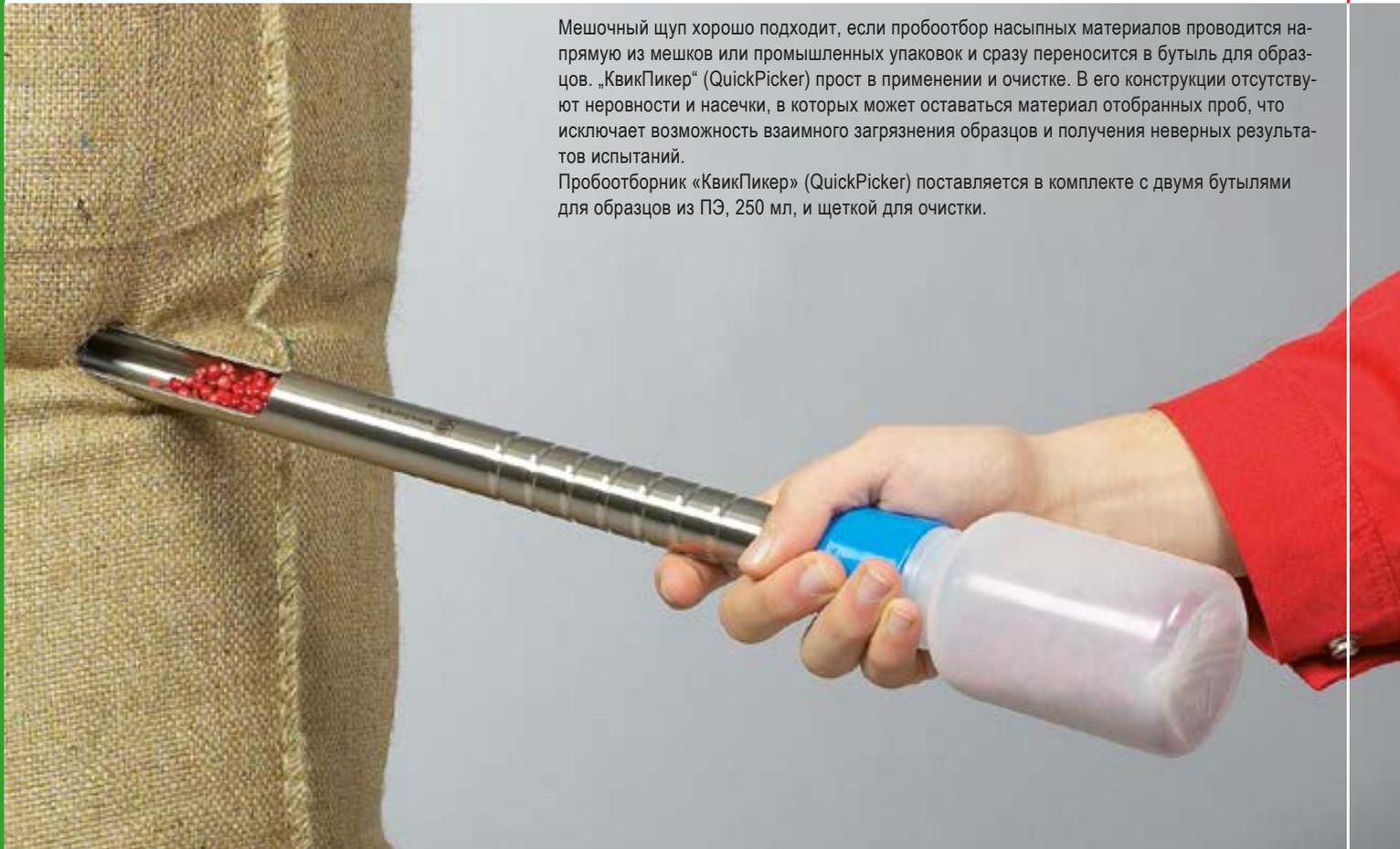
Мешочный щуп хорошо подходит, если пробоотбор насыпных материалов проводится напрямую из мешков или промышленных упаковок и сразу переносится в бутылку для образцов. «КвикПикер» (QuickPicker) прост в применении и очистке. В его конструкции отсутствуют неровности и насечки, в которых может оставаться материал отобранных проб, что исключает возможность взаимного загрязнения образцов и получения неверных результатов испытаний.
