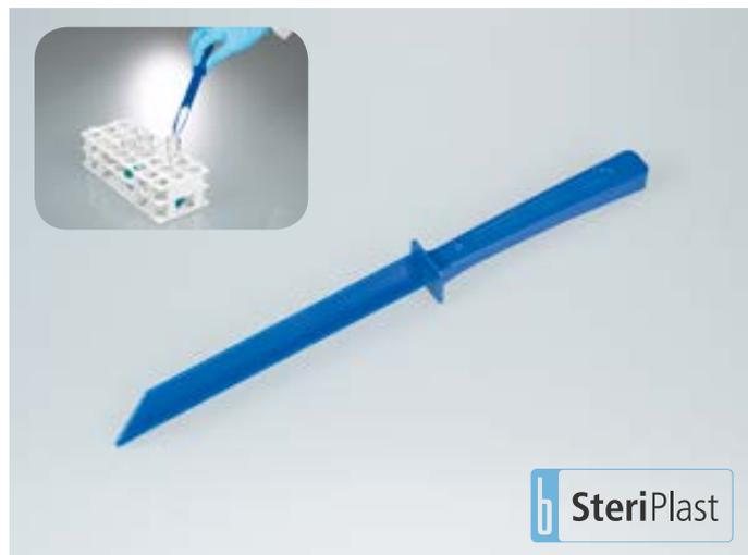
Шпатель для пищевых продуктов «СтериПласт» (SteriPlast®) из синего полистирола изготавливается в нашей чистой комнате класса 7 (10.000). Он собирается, раздельно упаковывается для одноразового применения, а затем стерилизуется гамма-излучением.
