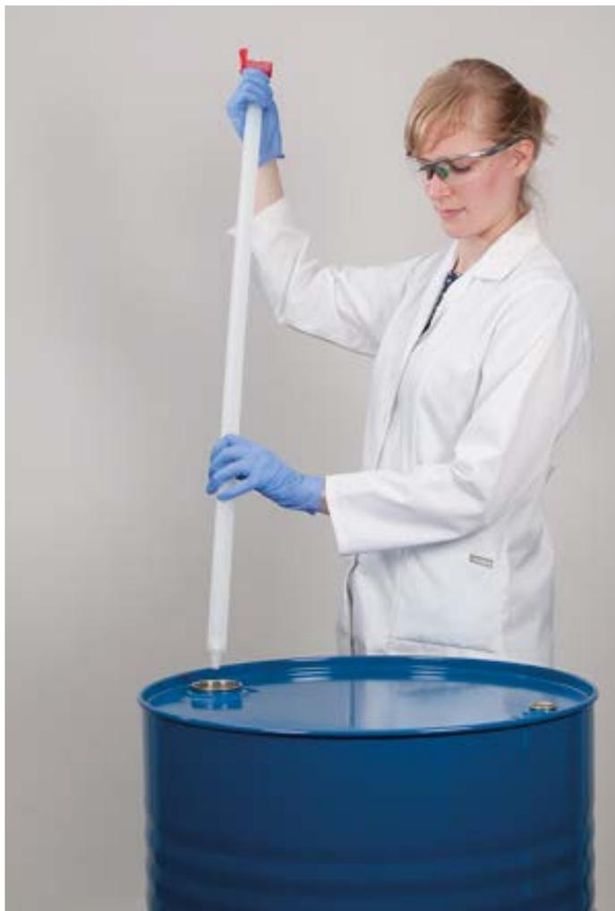
Погружной пробоотборник предназначен для простого отбора проб жидкостей. Содержимое хорошо видно через прозрачные трубки. Верхний торец пробоотборника снабжен обратным клапаном, нижний – шаровым краном.
