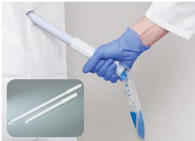
Одноразовый пробоотборник «ДиспоЛанс» (DispoLance) позволяет осуществлять быстрый и удобный отбор проб малых и больших объемов непосредственно из мешков. Приемник подходит для работы со свободно текучими порошками и мелкозернистыми гранулятами. Жесткий кончик пробоотборника «ДиспоЛанс» (DispoLance) втыкается в упаковку, проба перемещается по открытой внутренней трубке непосредственно в располагаемый ниже контейнер или пакет.
