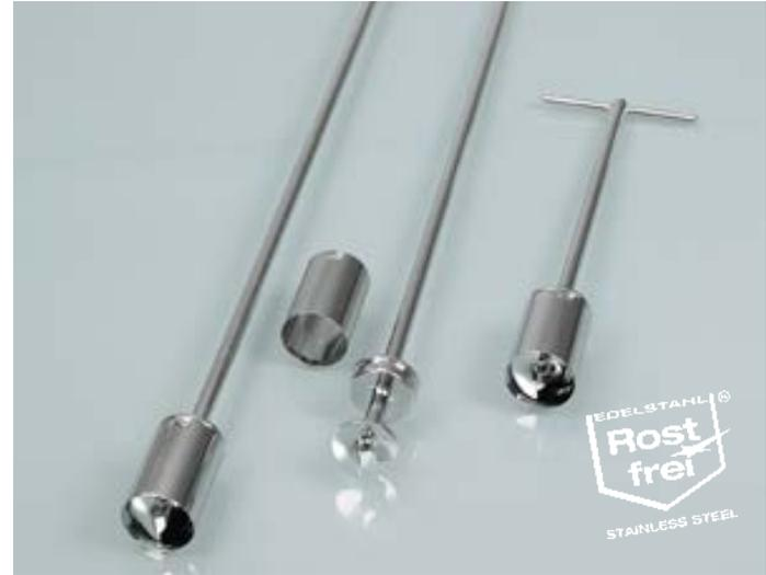
Пробоотборник предназначен для отбора бактериологических проб с поверхности туш животных (крупного рогатого скота, свиней, овец, коз и лошадей) на скотобойнях и в местах реализации мясной продукции. «БифСтикер» (BeefSteaker) срезает круглый участок кожи диаметром 25 мм. Простота отбора проб обусловлена остротой режущей кромки из нержавеющей стали.
