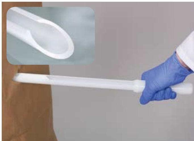
Одноразовый пробоотборник «ПаудерДиспо» (PowderDispo) специально предназначен для отбора проб из разных слоёв порошковых или слегка липких субстанций. Благодаря наличию трубки обеспечивается возможность взятия полной многоуровневой пробы из мешков или небольших ёмкостей.
