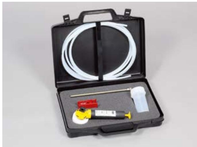
Прекрасно подходит для отбора проб из бочек, канистр, баков. Пробоотборник «МиниСамплер» (MiniSampler), ПЭ, с аксессуарами в чехле для транспортировки. В комплекте: 1 вакуумный насос, 10 бутылей (100 мл, полиэтилен), всасывающий шланг 6x8 мм (10 м, полиэтилен), 1 нож для шлангов, 1 груз для шлангов (нержавеющая сталь V4A (1.4404)/никелированная латунь), 20 пломб «Сил-Ит» (seal-It).
