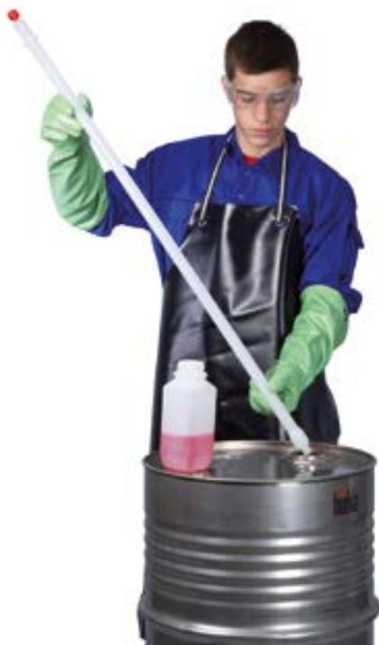
Пробоотборник «ЛиквиСамплер» (LiquiSampler) для жидкостей соответствует требованиям стандарта DIN EN ISO 15528. Изготовлен из высокочистого и химически инертного ПТФЭ/ФЭП или ПП, что позволяет избежать загрязнения пробы посторонними веществами.
