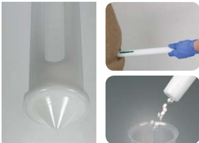
«ТаргетДиспо» (TargetDispo) позволяет производить точечный пробоотбор на заранее точно определённом участке исследуемого материала. Приёмник вводится в закрытом состоянии в порошок или гранулят, открывается на месте отбора пробы и потом снова закрывается. Таким образом осуществляется высокоточный точечный пробоотбор. Выгрузка пробы может быть легко осуществлена через открытую ручку.
