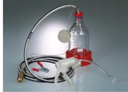
Пробоотборник «УниСамплер» (UniSampler) с гибкой трубкой (ПВХ) и грузом, изготовленным из нержавеющей стали. Предназначен для отбора проб с большой глубиной, из труднодоступных мест. Тяжелая металлическая трубка служит для погружения подающей трубки на заданную глубину.
