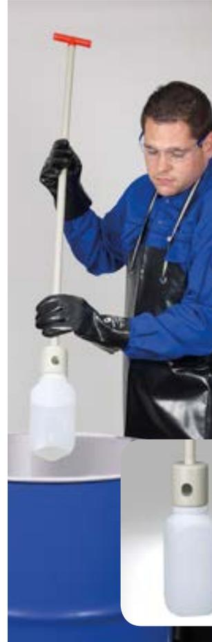
Пробоотборник „ХимоСамплер“ (ChemoSampler) был создан для отбора проб агрессивных жидкостей, в том числе кислот, щелочей, моющих средств. Отбираемая проба поступает непосредственно в оригинальную бутылку для образцов. Конструкция крышки бутылки с оригинальным предохранительным кольцом обеспечивает полную сохранность образца при транспортировке. Использование удлинительного штока позволяет проводить отбор образцов с глубины до 200 см, в том числе из цистерн, зернохранилищ или баков.
