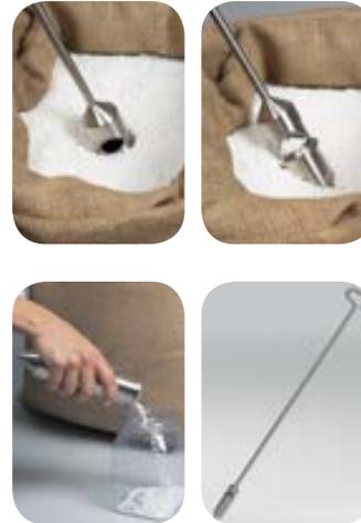
Пробоотборник „СилоПикер“ (SiloPicker) идеально подходит для отбора проб насыпных материалов из зернохранилищ. С помощью удлинительных штоков возможен отбор пробы с глубины до 3,5 м. Глубина погружения в отбираемый материал зависит от плотности сыпучих материалов.
