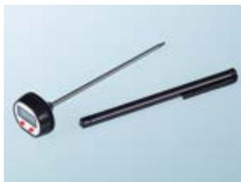
Термометр погружного типа предназначен для измерения температуры газов, порошков, жидкостей и пластичных материалов.
