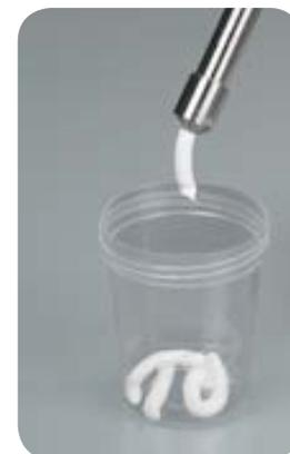
Для отбора проб вязких веществ, в том числе паст, донных отложений, кремов, нефти. Проба всасывается с помощью поршневого штока и поступает в контейнер для образцов. Простота очистки обеспечивает высокое качество отбираемых проб. При необходимости, в зависимости от вязкости пробы, съемная всасывающая головка пробоотборника может быть дополнительно снабжена всасывающими отверстиями от 2 до 6 мм.
