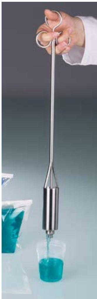
Пробоотборник для жидких и вязких жидкостей. При работе одна рука остается свободной. С выпускной воронкой для безопасного заполнения бутылей для образцов. Нержавеющая сталь V4A (1.4404).
