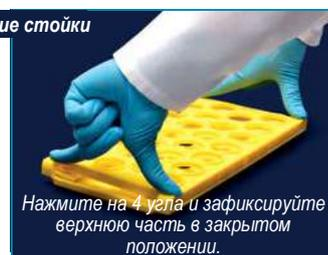
Нажмите на 4 угла и зафиксируйте верхнюю часть в закрытом положении.
