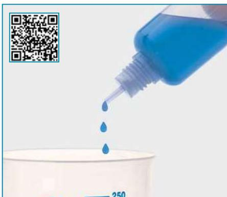
➤ Изготовлены из прозрачного полиэтилена, с крышкой-капельницей. Крышку можно легко снять для очистки.
