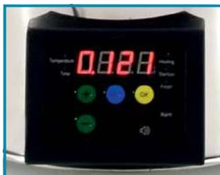
Оснащен электронным таймером с ЖК-дисплеем, обеспечивающим управление по времени в диапазоне 1-99 минут.
