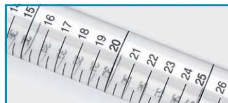
Четкая идентификация объема по хорошо различимой двухнаправленной градуировке, напечатанной на боковой поверхности пипетки.
