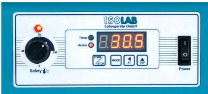
Мембранная клавиатура и цифровая ЖК-панель, с функциями таймера, сигнализации и автонастройки. Таймер с функцией задержки включения/выключения может быть настроен в диапазоне 99 минут 59 секунд или 99 часов 59 минут.
