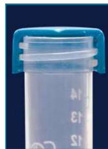
Уникальная конструкция крышки с рифлением позволяет закрывать и открывать ее одной рукой. 3/4 оборота крышки достаточно для герметичного укупоривания пробирки.
