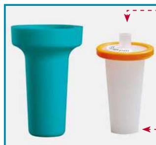
Сменный гидрофобный фильтр из PTFE с толщиной фильтрации 0,45 мкм предотвращает перекрестную контаминацию.
