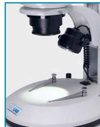
Оснащен блоком питания от сети 100 В - 220 В и суперярким и мощным освещением. **Светодиодное освещение сверху.**
