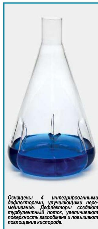
Оснащены 4 интегрированными дефлекторами, улучшающими перемешивание. Дефлекторы создают турбулентный поток, увеличивают поверхность газообмена и повышают поглощение кислорода.
