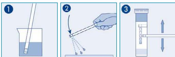
Погрузить индикаторную полоску в пробу на одну секунду. Стряхнуть излишнюю жидкость и положить полоску на горизонтальную поверхность. Считать результат, сравнив индикаторное поле с цветовой шкалой.
