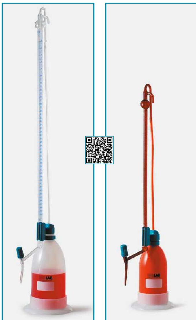
➤ Изготовлены из вакуум-калиброванного боросиликатного стекла 3.3 в соответствии со стандартом ISO 385. Выполнена калибровка в соответствии со стандартом DIN/ISO, класс «AS».
