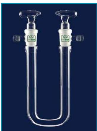
► Изготовлены из жаропрочного, химически устойчивого боросиликатного стекла в соответствии со стандартом DIN 12616, U-образной формы, оснащены краном.
