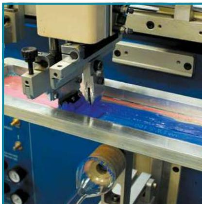
Только высококонтрастная и четкая печать позволяет точное считывание со снабженных шкалой продуктов, например, цилиндров, бюреток, пипеток и т. д.
