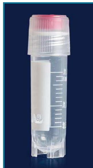
Градировка на боковой стенке обеспечивает визуальный контроль объема.
