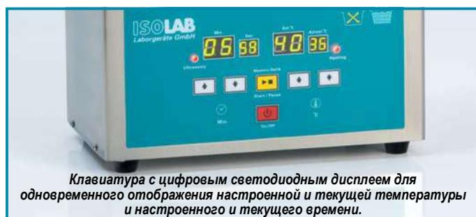
Клавиатура с цифровым светодиодным дисплеем для одновременного отображения настроенной и текущей температуры и настроенного и текущего времени.
