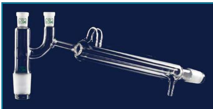
► Изготовлены из жаропрочного, химически устойчивого боросиликатного стекла, с конденсатором Либиха, с двумя втулками NS 14/23, предназначенными для использования с термометрами.
