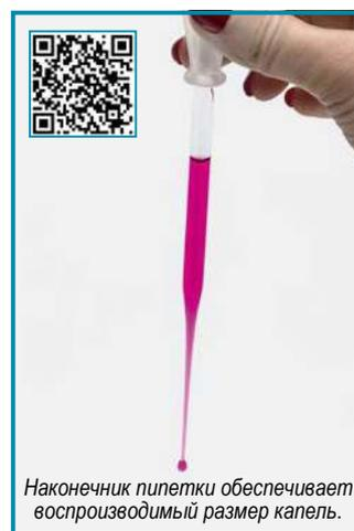
Наконечник пипетки обеспечивает воспроизводимый размер капель.
