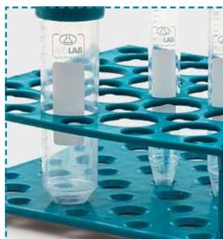
Отверстия в нижней пластине гарантируют прочную фиксацию пробирок в нужном положении.
