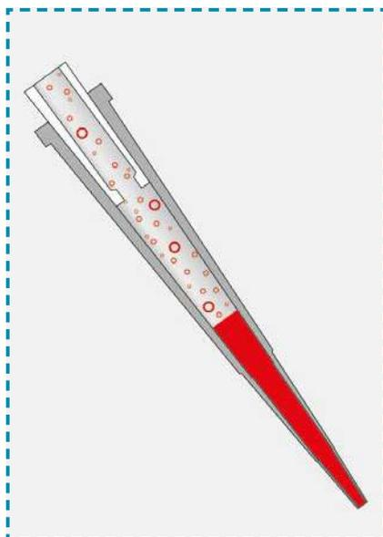
**ISOLAB** наконечники с фильтром обеспечивают непревзойденную защиту от контаминации.
