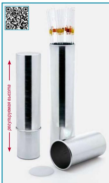
➤ Изготовлен из чистого алюминия, цилиндрической формы. Для крепления пипеток с различной высотой во время процесса автоклавной стерилизации. Общую высоту контейнера можно регулировать.
