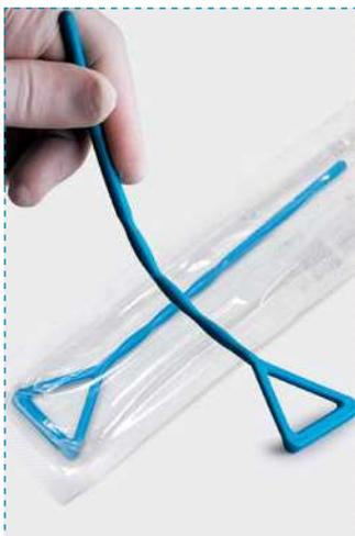
*Ручка слегка сгибается под давлением, позволяя треугольной головке оказывать идеальное, равномерно распределенное и однородное давление на поверхность агара.*
