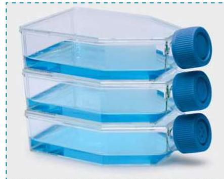
Эргономичная конструкция минимизирует контаминацию, и приподнятые углы корпуса позволяют легкую возможность укладки друг на друга без проскальзывания.
