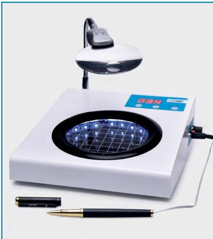
➤ Идеальное средство для быстрого и удобного подсчета колоний вручную на агаре в чашках Петри. Универсальная конструкция позволяет принимать чашки Петри с диаметром от 40 мм до 100 мм.
