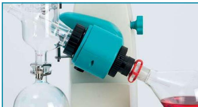
Оснащены регулируемой системой распознавания конечного положения для защиты стеклянных компонентов от разламывания. Уникальное выталкивающее устройство служит для освобождения колбы и защищает ее от разламывания.
