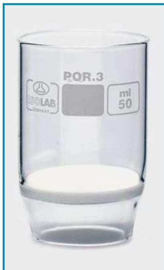
➤ Изготовлены из жаропрочного, химически устойчивого боросиликатного стекла, с кислотостойким стеклокерамическим диском для фильтрации.
