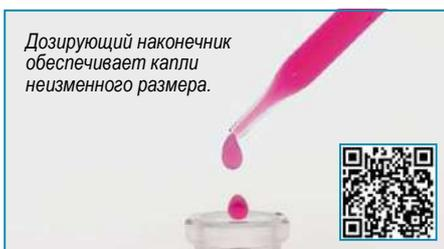
Дозирующий наконечник обеспечивает капли неизменного размера.
