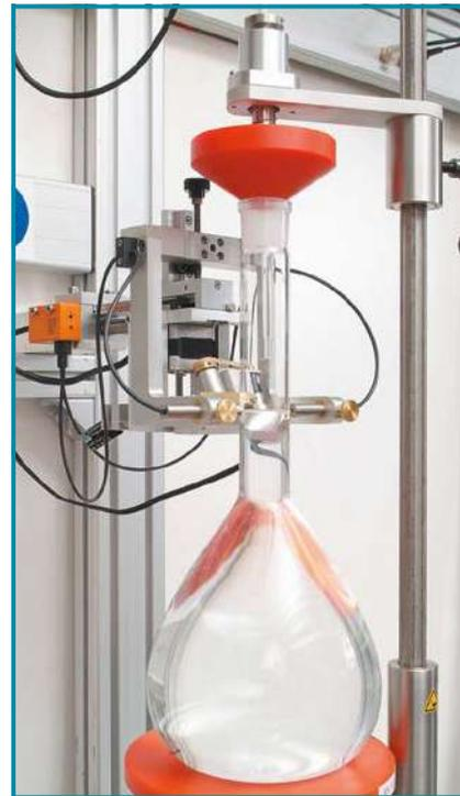
Наполнение заготовок водой выполняется автоматически калибровочными машинами.
