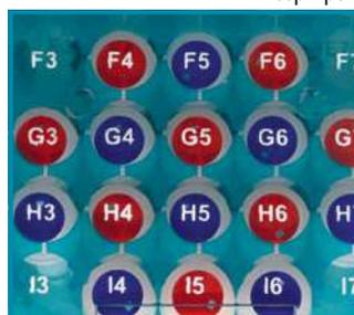
Буквенно-цифровой указатель на рядах пробирок и на крышке обеспечивает простую идентификацию местоположения кювет.
