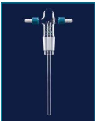
► Изготовлены из жаропрочного, химически устойчивого боросиликатного стекла, без стеклокерамической опоры.
