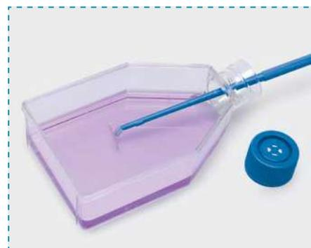
Наклонная конструкция горлышка колбы предоставляет легкий доступ к любому углу с 100%-ным извлечением клеток, не оставляя мертвых зон.
