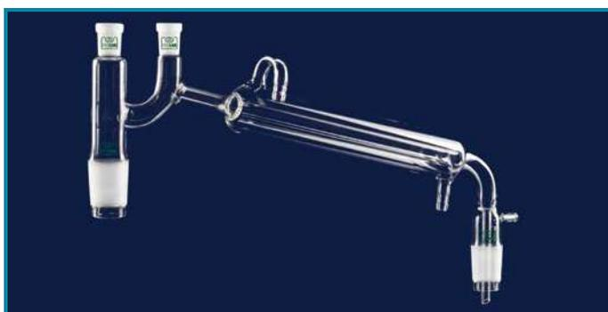
► Изготовлены из жаропрочного, химически устойчивого боросиликатного стекла, с конденсатором Либиха, с двумя втулками NS 14/23, предназначенными для использования с термометрами. Оснащены вакуумным соединительным адаптером.
