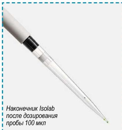
Наконечник Isolab после дозирования пробы 100 мкл
