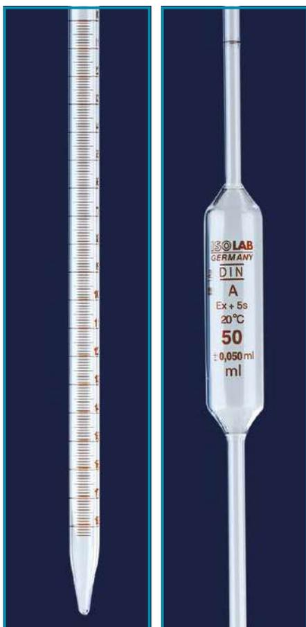
➤ Изготовлены из нейтрального стекла в соответствии со стандартами ISO 648 и DIN 12687, ISO 835 и DIN 12699.
