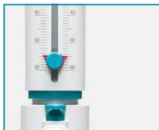
Шкала, напечатанная на обеих сторонах корпуса, обеспечивает точное считывание значений объема.
