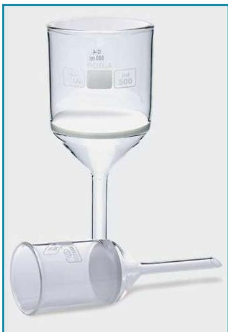
➤ Изготовлены из жаропрочного, химически устойчивого боросиликатного стекла, с кислотостойким стеклокерамическим диском для фильтрации.
