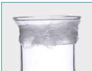
Обладает предельно хорошими растягивающими и адгезионными свойствами. Прекрасное средство для герметизации и упаковки различной лабораторной посуды.
