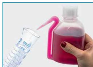
*Дозирующий наконечник обеспечивает предельно тонкую струю. Для увеличения расхода жидкости можно срезать конец подающей трубки.*
