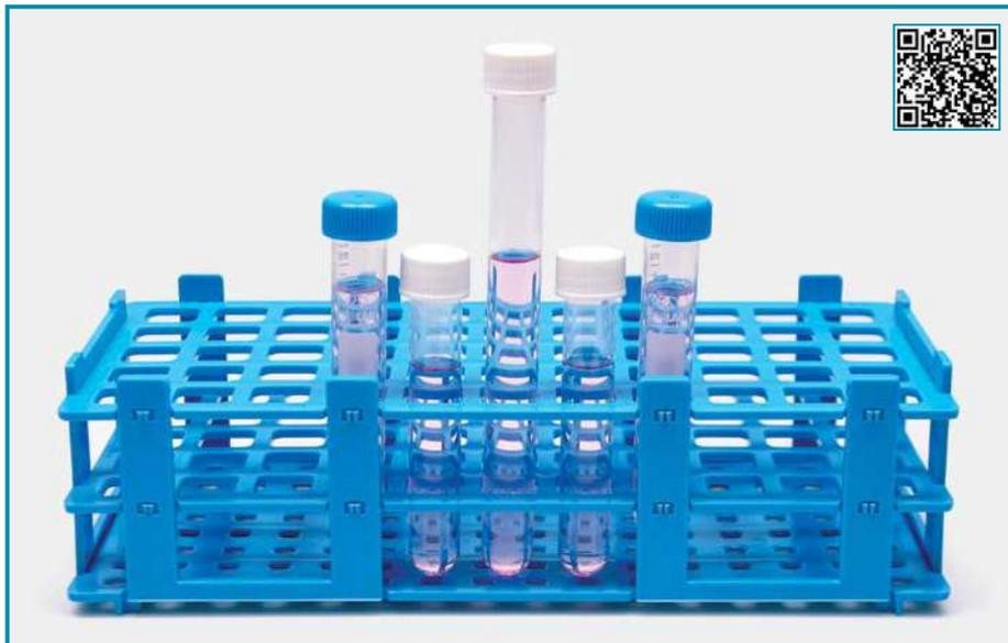
➤ Изготовлены из модифицированного полипропилена, позволяющего использовать стойки в водяных банях без всплытия.
