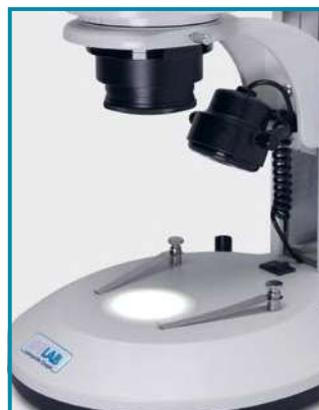
Оснащен блоком питания от сети 100 В - 220 В и суперярким и мощным освещением. **Светодиодное освещение снизу.**
