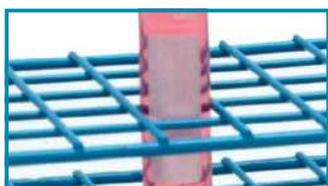
Квадратные отверстия для пробирок и разрезное основание обеспечивают надежную фиксацию пробирок в точном положении.
