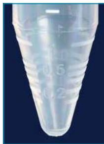
Точная маркировка объема на основании пробирки точно и четко указывает объем жидкости.
