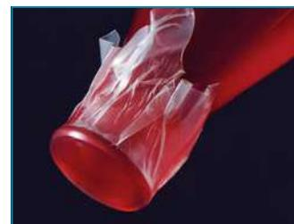
Наматывается вокруг горлышка колбы и герметично уплотняет периметры колб, колб Эрленмейера, бутылок, лабораторных стаканов и т. п.
