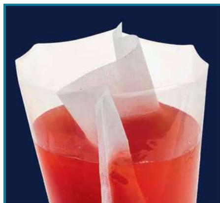
Пакеты с полным поверхностным фильтром разделены на 2 равных отделения. После гомогенизации твердая проба остается в одном отделении, в то время как жидкая фаза переливается в другое.
