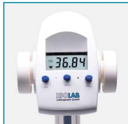
Наклонный, большой 4-разрядный ЖК-дисплей четко показывает значения титрования до 99,99 мл и предотвращает ошибки считывания уровня мениска.
