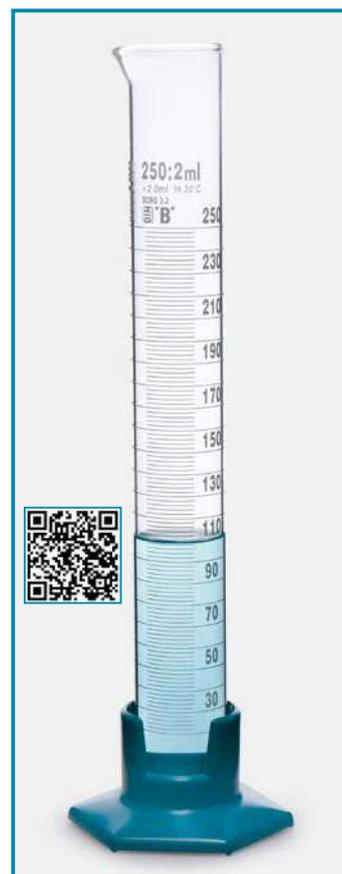
➤ Изготовлены из жаропрочного, химически устойчивого боросиликатного стекла в соответствии со стандартом DIN ISO, класс «В».
