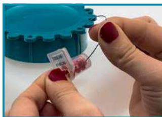
Вставьте пломбировочную проволоку в отверстия крышки и самой бутылки. Затем вставьте проволоку в отверстие пломбы, как показано на рисунке.
