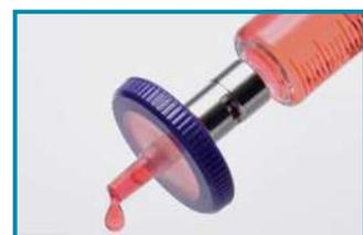
➤ Изготовлен из боросиликатного стекла. Оснащены системой Люэр-Лок из нержавеющей стали.
