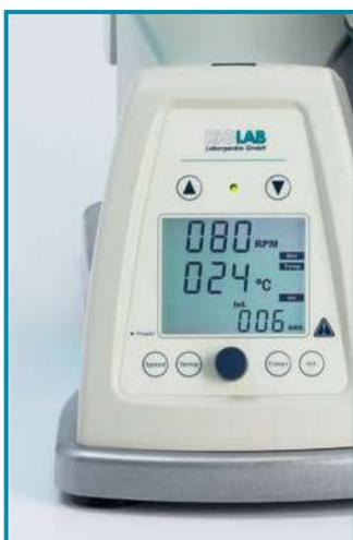
Интегрированная панель управления для удобного управления основным узлом и нагревательной баней.
