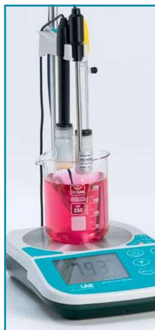
Настольные измерительные приборы имеют специальную платформу сопряжения с магнитной мешалкой, что позволяет быстро получать точные результаты измерений.
