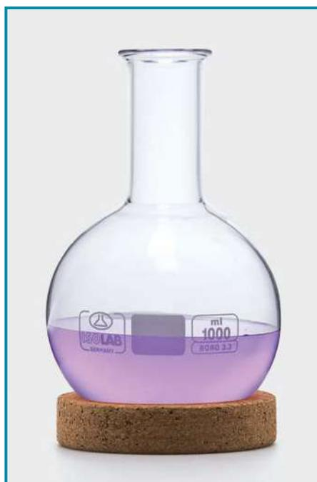
➤ Изготовлены из высококачественной, жаропрочной, непористой, натуральной пробки, служат для фиксации колб с круглым основанием.
