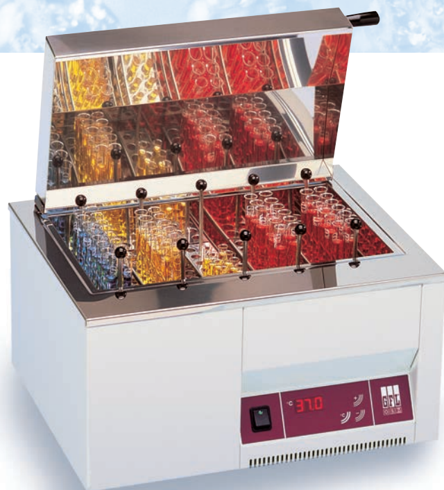
1013 водяная баня с системой циркуляции, 14 литров
