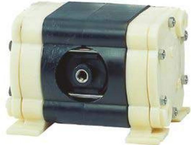
Насос с двойной диафрагмой работает на сжатом воздухе и предназначен для перекачки вязких, коррозионноактивных, абразивных и горючих жидкостей. В исполнении 1/4". Насосы изготовлены из полипропилена, ПВДФ или ПА. Диафрагмы, краны и седла клапанов изготовлены из термопластичных эластомеров геоласт и сантопрен, а также ПТФЭ. С помощью насоса можно перекачивать суспензии с диаметром частиц до 1,6 мм.
