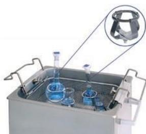
Пружинные зажимы EK для лабораторных колб
