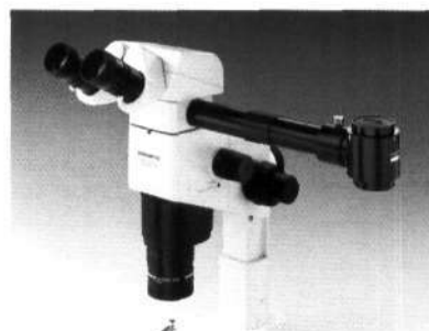
Рисовальная насадка. Используется для карандашной зарисовки объектов и макрофотосъемки.
