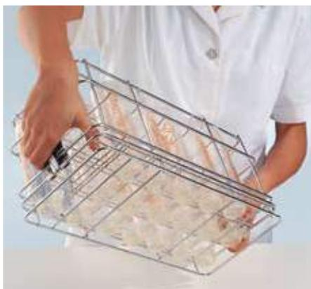
2. Контейнер закрывается крышкой (сетчатой). Затем контейнер поворачивается на 180° (горлышками бутылок вниз) и устанавливается в дезинфектор.
