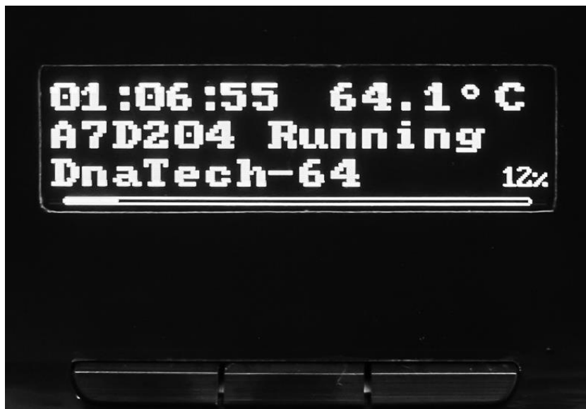
Рис.3. Жидкокристаллический индикатор и кнопки управления
