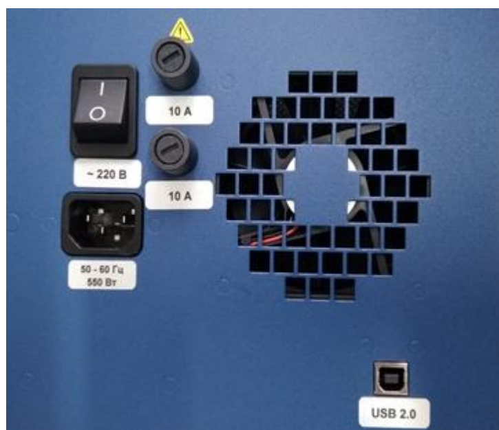
Рис.3. Расположение разъемов на задней панели прибора
