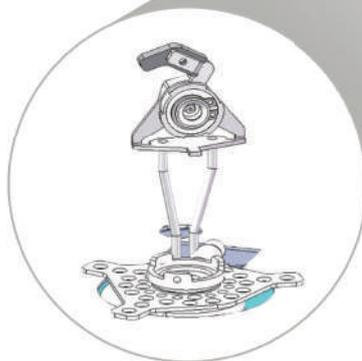
Испаритель с быстросъемной крышкой позволяет максимально быстро проводить замену лайнера и техническое обслуживание без специальных инструментов.
