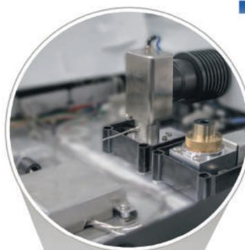
■ ■ ■ Газовый хроматограф Sintecon GC A500.1 может быть оснащен тремя детекторами, что расширяет область его применения.
