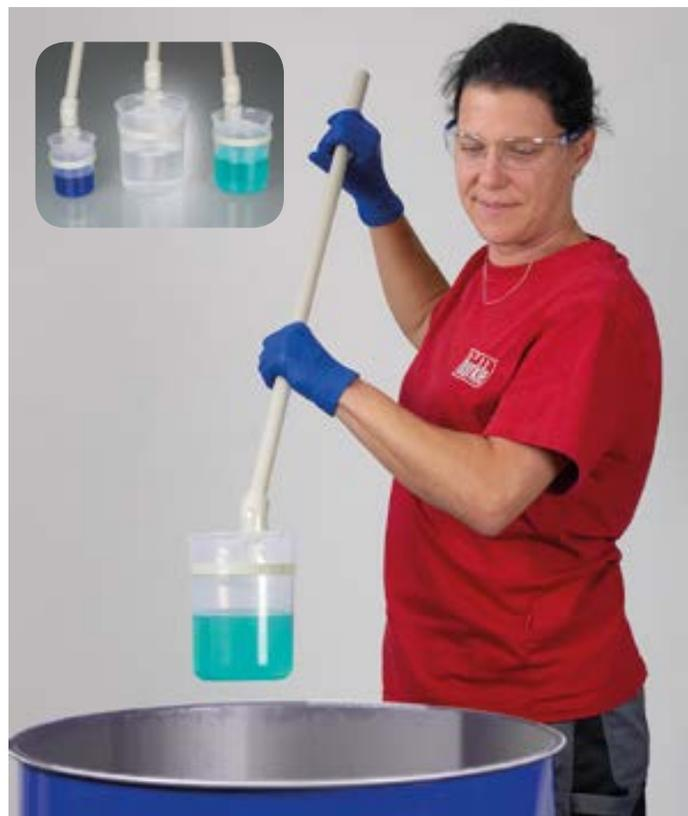
Предназначен для отбора проб агрессивных жидкостей. Жесткий шток изготовлен из полипропилена.
