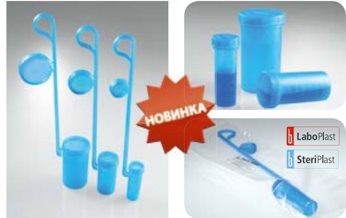
Погружная пробирка, изготовленная в условиях чистой комнаты, для отбора проб специально для одноразового применения. По причине синего цвета также идеально подходит для применения в пищевой, кормовой и фармацевтической промышленности. Контейнер для проб со шкалой обеспечивает точный замер. После отбора пробы контейнер можно герметизировать от воздействия жидкостей (см. стр. 130).
